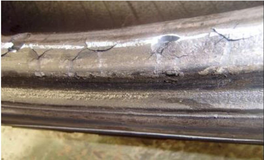
FIGURA 5: Talão danificado FONTE: Empresa de ônibus, 2010.
