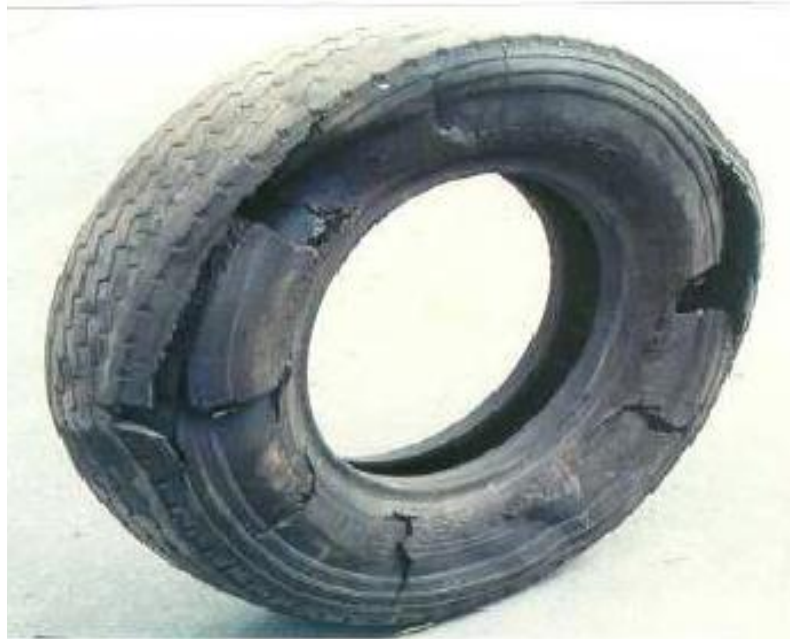
FIGURA 6: Pneu que sofreu sobre carga, pressão insuficiente FONTE: Empresa de ônibus, 2010.
