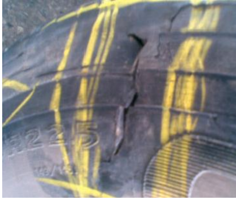
FIGURA 7: Pneu que sofreu impacto, fricção nos flancos FONTE: Empresa de ônibus, 2010.
